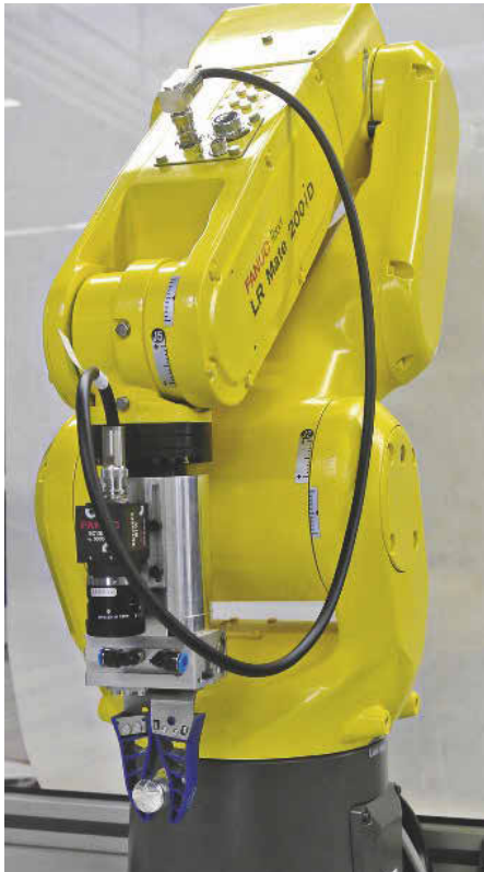
Zum Einsatz kommt ein Fanuc Langarm-Miniroboter LR Mate 200 iD/7L. Bild: Maier
