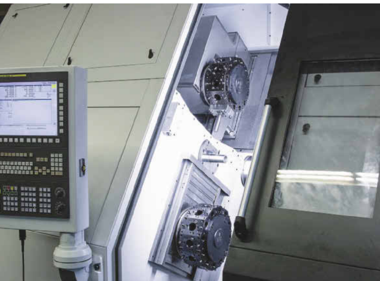
Abb.4.: Blick in den Arbeitsraum der ML60F3.5, Führungsbuchse mit Revolver.
